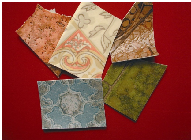
2 Les revêtements de sols multicouches sont généralement composés de PVC et d'une sous-couche d'amiante faiblement aggloméré.
